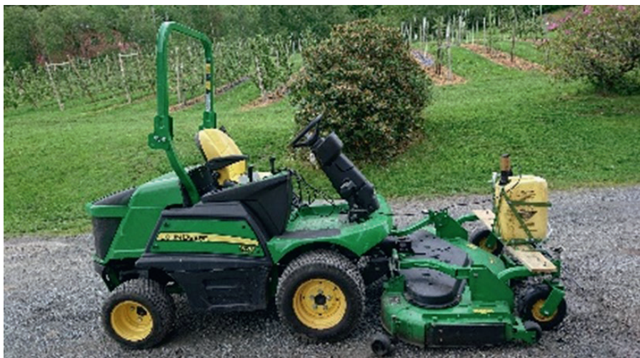
Figur 5. Plantevitaliseringsprøyte for slått mellom fruktradene, der ferment vert dusja ut medan ein slår. Patent: Morten Fosse. John Deere 1570 med Serigstad EL syreutstyr og bom GP5. Foto: L.H. Gilpin.
